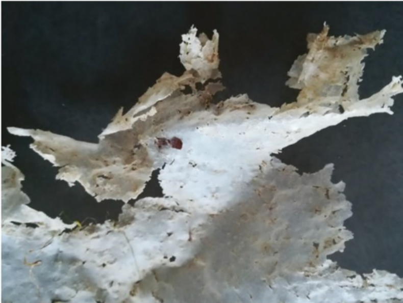
Abbildung 2: Plastikfolie (Polyethylen) aus der Kinzig mit Löchern vom mechanischen Abrieb (nach Fath [11]).
